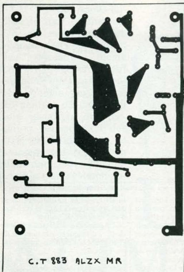
Fig. 2. Le circuit imprimé côté cuivre (échelle 1).
