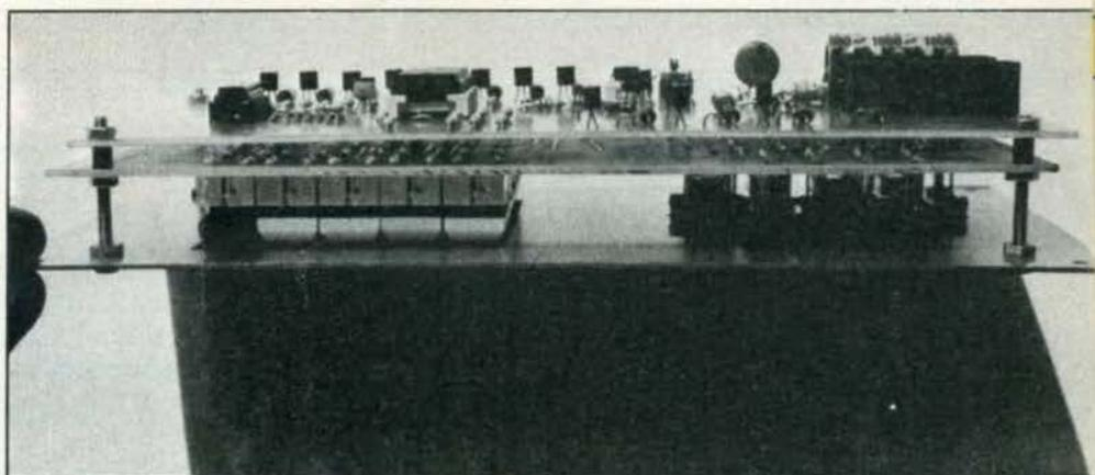
Disposition des deux circuits imprimés,
