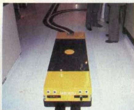
Véhicule à guidage optique (Matra).
