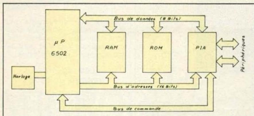
Fig. 1. Architecture typique d'un système à base de 6502.
