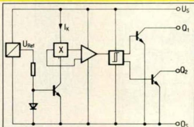
La sensibilité de 25 mT du TLE 4901 lui permet d'être commandé par des aimants ce qui simplifiera les problèmes de montage mécanique. Les deux applications suivantes tiendront lieu d'exemples :
