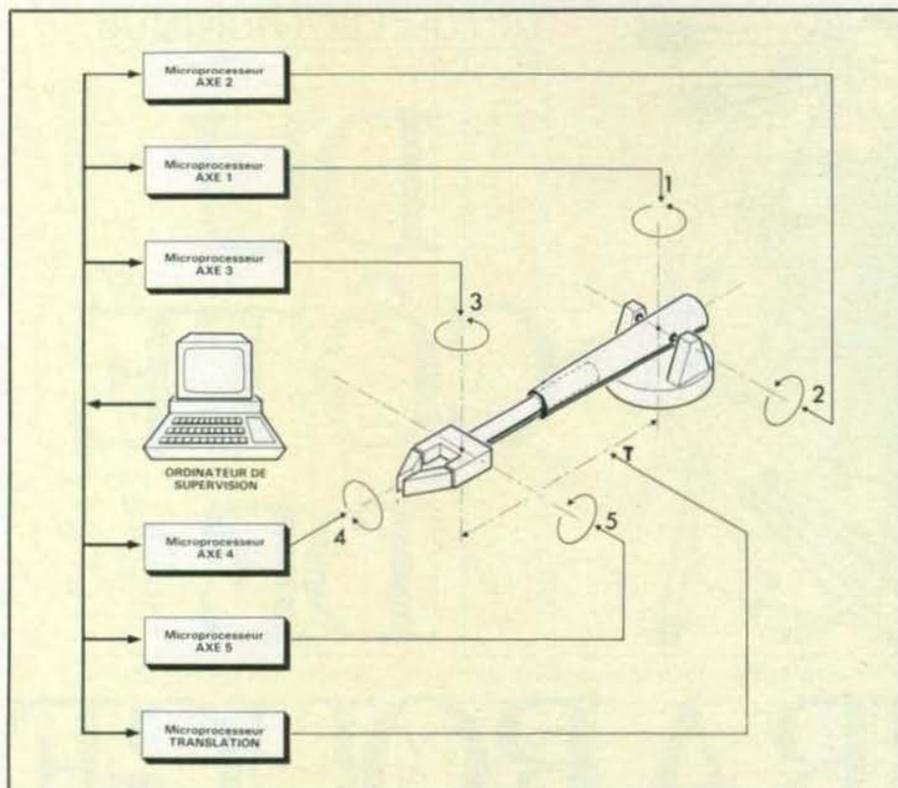
Schéma d'un bras rétractable avec pince et poignet (doc. Télésoft).
