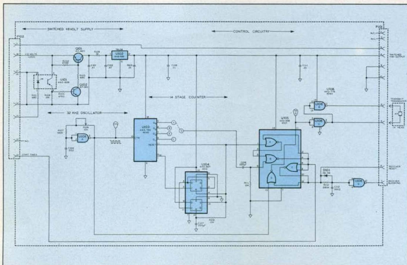
Le schéma de l'émetteur à ultrasons. Un photocoupleur commande l'interruption de l'alimentation.
