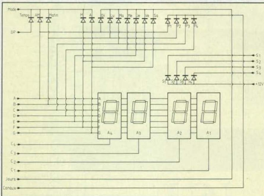
Fig. 2. Schéma de la fonction affichage.
