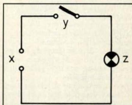
Figure 3. Un circuit ET élémentaire.
