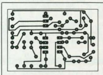
Fig. 2. Le circuit imprimé à l'échelle 1, vu du côté du cuivre.
