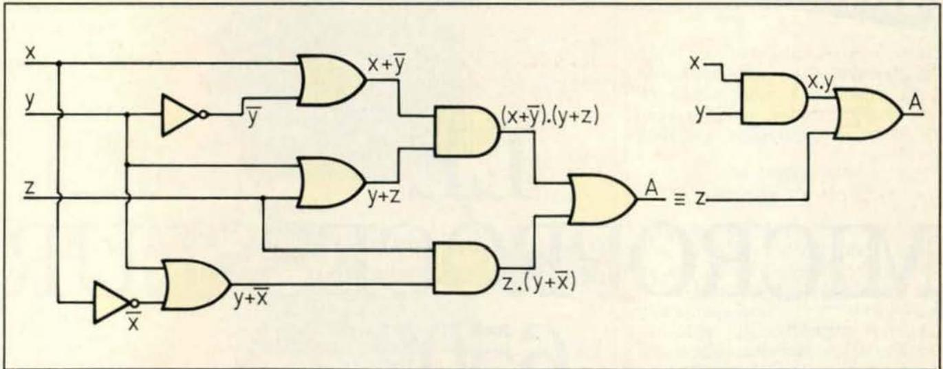
Figure 7. Deux circuiteries à comparer, avant et après simplification : l'économie est appréciable (voir texte).
