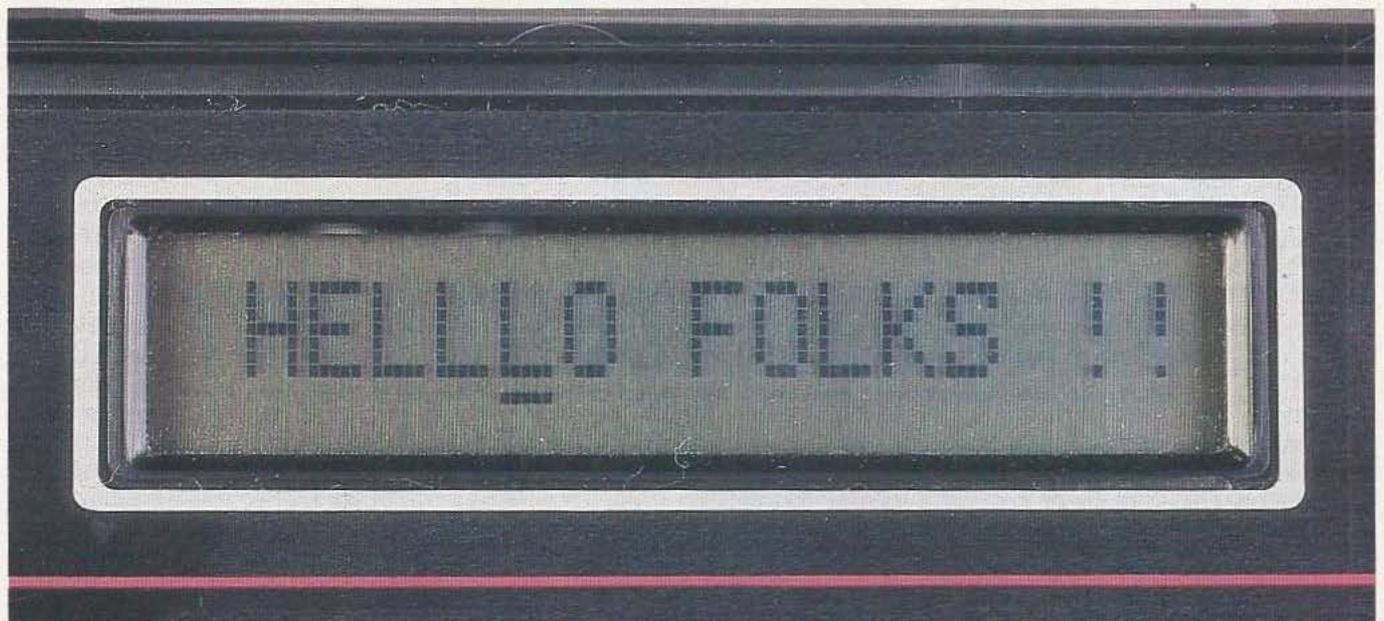
L'écran à cristaux liquides : on peut voir, ici, l'index de correction placé sous la lettre à effacer.
