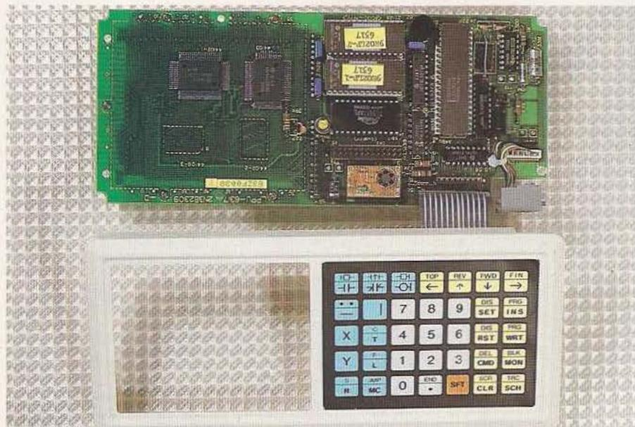
L'intérieur du boîtier de commande de l'AOIP.
