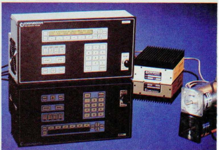
Compumotor : programmeur 16 bits de moteurs pas à pas.
