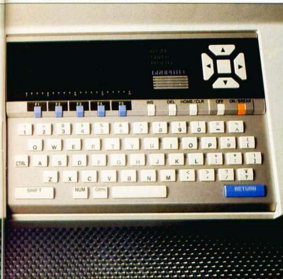
double précision (il faut la double précision pour les 14 chiffres) et dispose de fonctions graphiques de peu d'intérêt ici, vu les macro-commandes comprises par la table. Signalons la possibilité de travailler en décimal, octal et hexadécimal ainsi que la présence d'une horloge temps réel interne.
