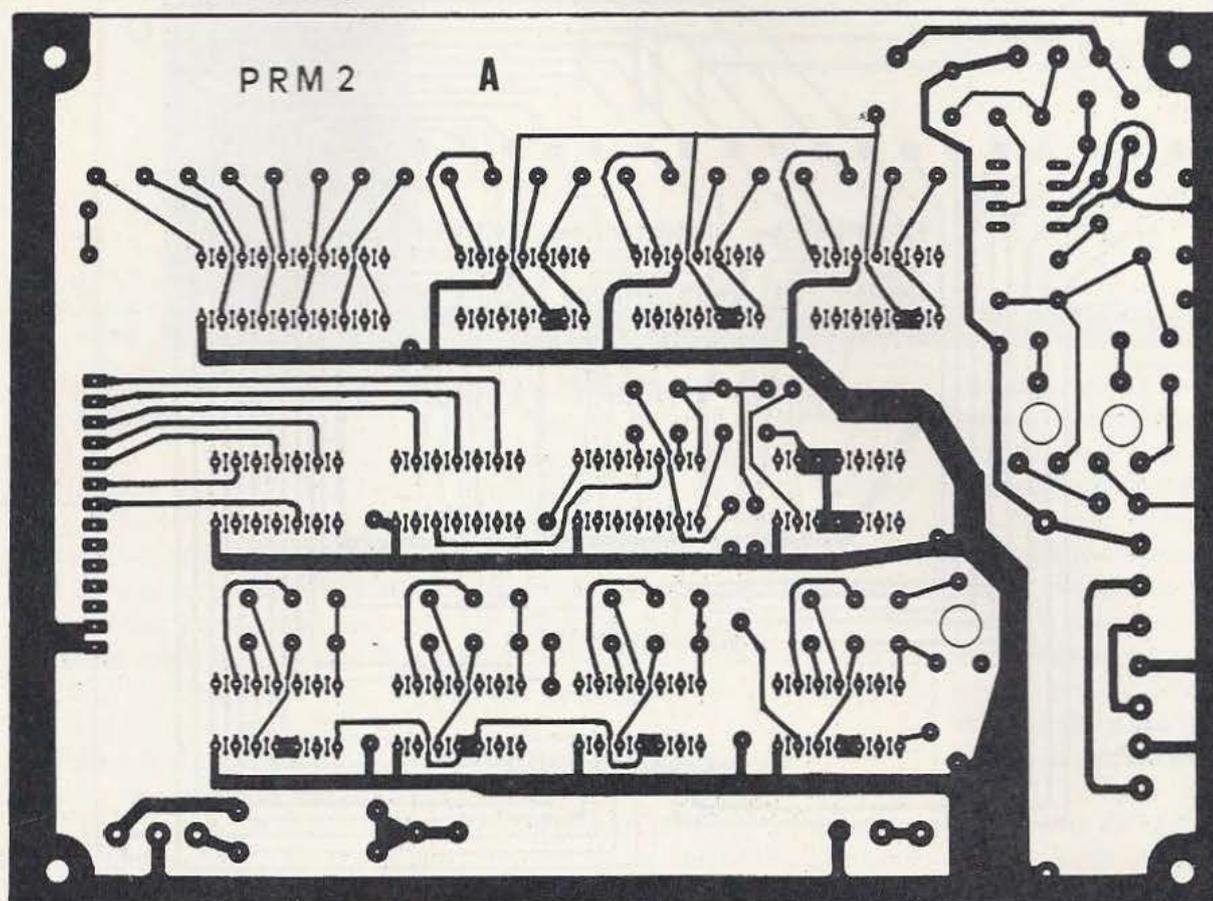
Fig. 10. Le circuit A (recto). Il est impératif de respecter la largeur des pistes.
