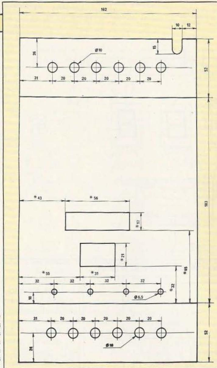
Fig.18. Le couvercle. Les cotes précédées de \* sont à déterminer en fonction des afficheurs.
