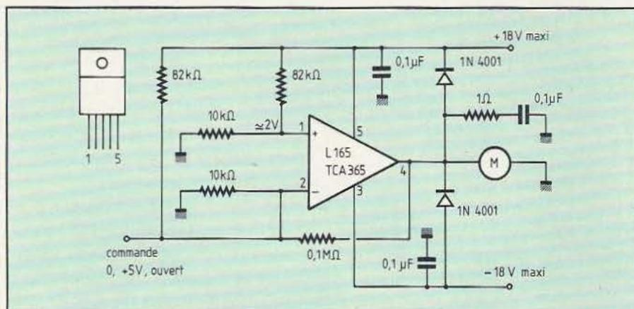
Fig. 2. Commande bidirectionnelle de moteur avec alimentation à point milieu.
