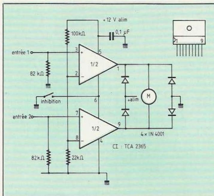
Fig. 5. Commande en pont avec double ampli TCA 2365.
