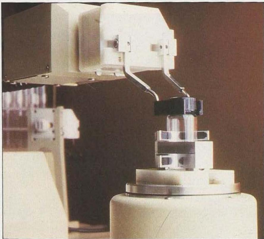
que la position de trois des quatre sommets du rectangle désignant le porte-tube; le contrôleur se chargera de calculer la position de chacun des tubes et procédera, en même temps, à l'indexation de ces tubes. Ces opérations inévitables effectuées, nous devons apprendre au robot les lieux où il devra aller ainsi que le travail qu'il aura à faire en ces lieux. Ici nous aurons les notions de positions absolues
