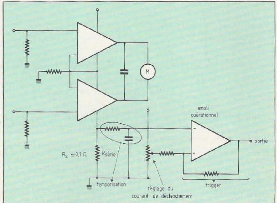
Fig. 7. Principe d'une limitation en courant et d'une temporisation.
