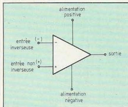
Fig. 1. L'amplificateur opérationnel.
