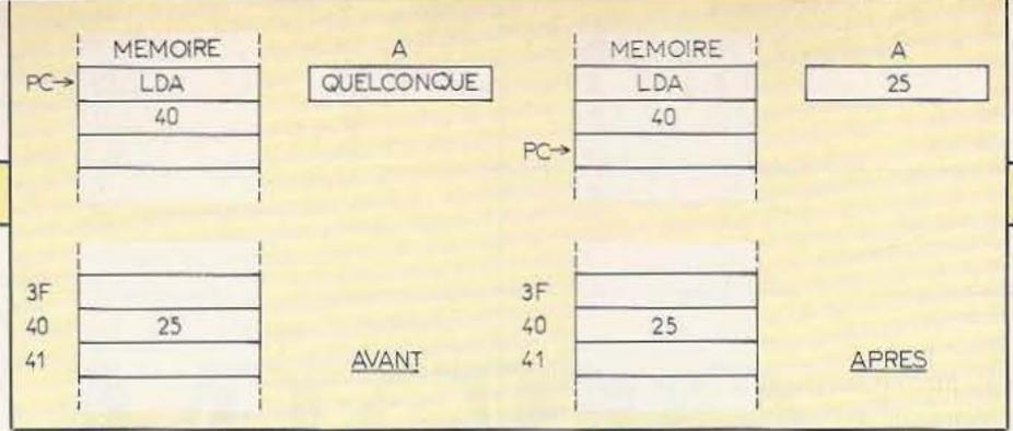
Fig. 3. Principe de l'adressage direct.
