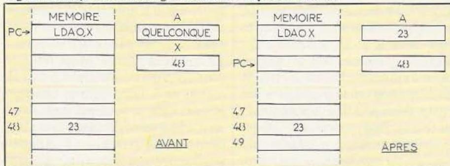
Fig. 6. Principe de l'adressage indexé avec déplacement sur 8 bits.
