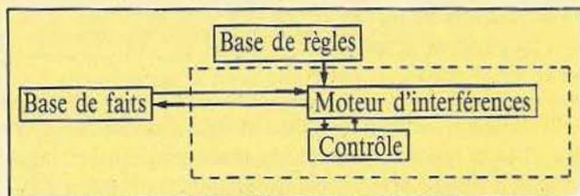
Sur ce schéma n'apparaissent pas les nombreux modules d'interface avec l'utilisateur, pour introduire des connaissances, comprendre les résultats (module d'explication), etc. Ils n'entrent pas dans la structure de base du système de production, mais sont bien sûr indispensables à tout «bon» S.E.
