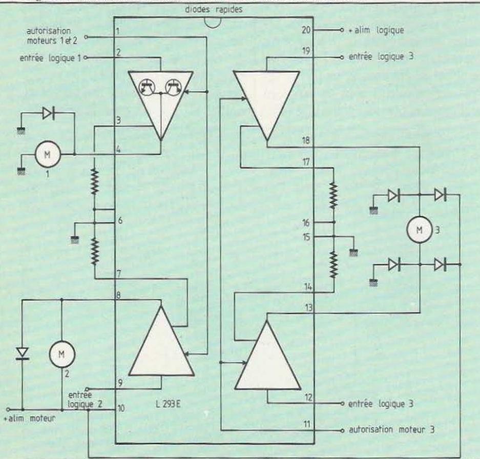
la basse impédance interne des circuits de commande, le coefficient de surtension des bobinages du moteur se maintient à un niveau très bas, si bien que les surtensions n'atteignent pas de valeur prohibitive. Ce circuit intégré permet de réaliser une commande simple, économique et peu encombrante.
