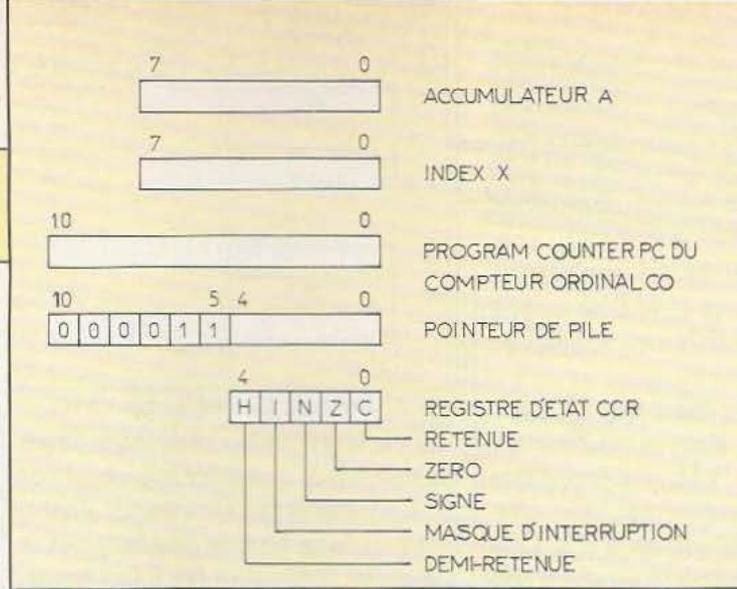
Fig. 1. Le modèle du programmeur du 68705.
