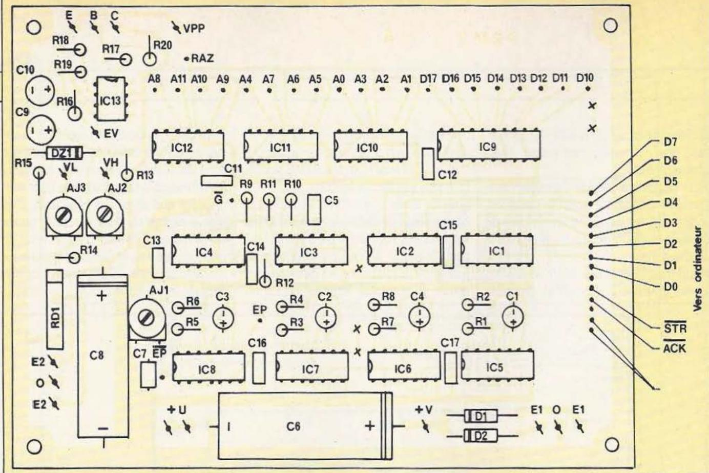
Fig. 14. Implantation des composants sur le circuit principal.
