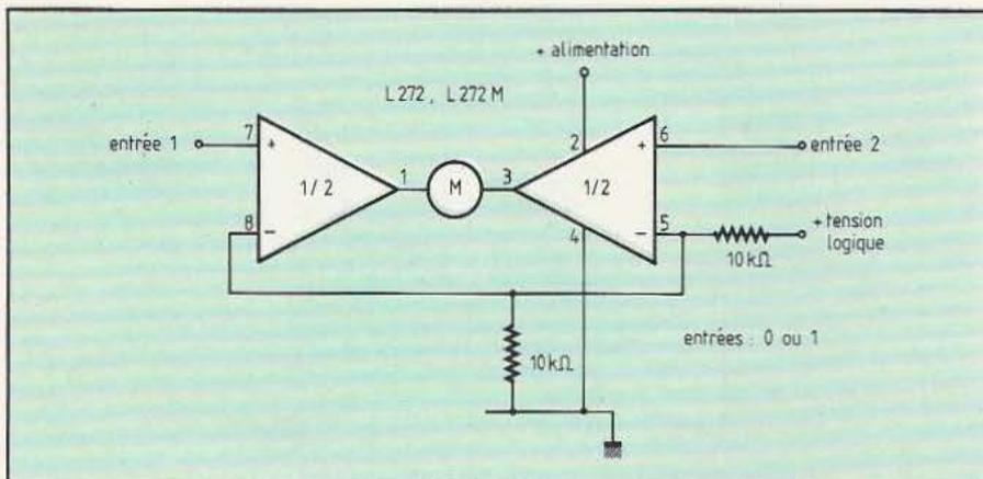
Fig. 4. Commande bidirectionnelle par circuit L272M.
