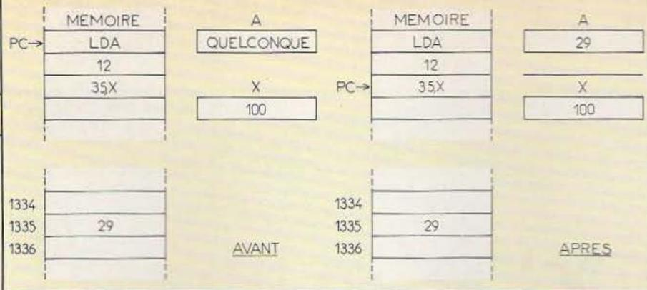
Fig. 7. Principe de l'adressage indexé avec déplacement sur 16 bits.
