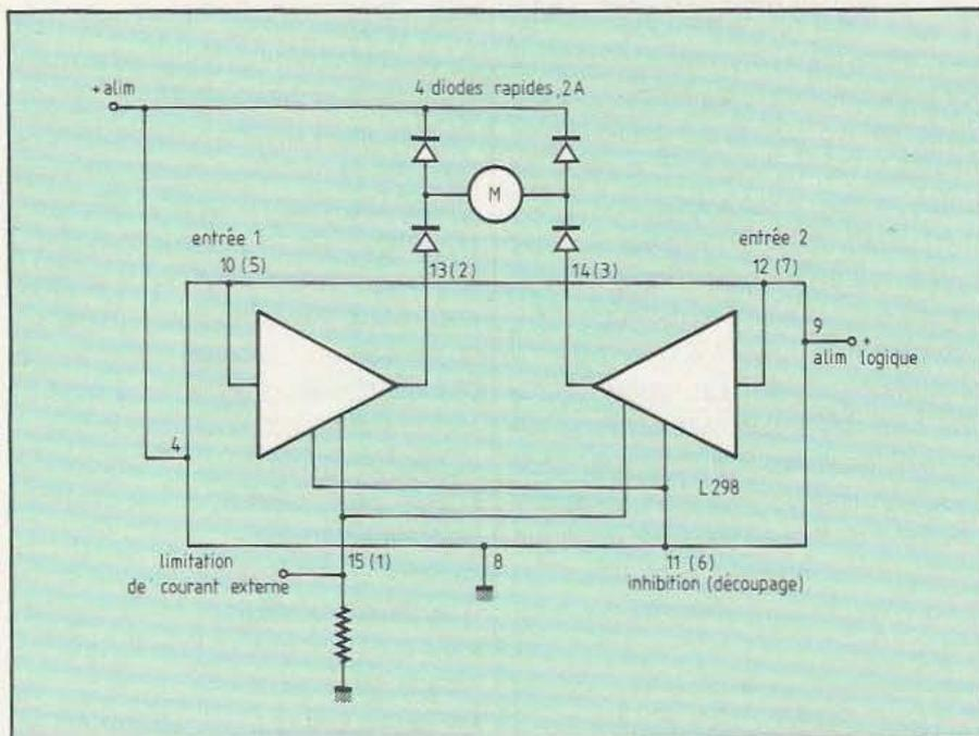
Fig. 10. Schéma d'application du L298.
