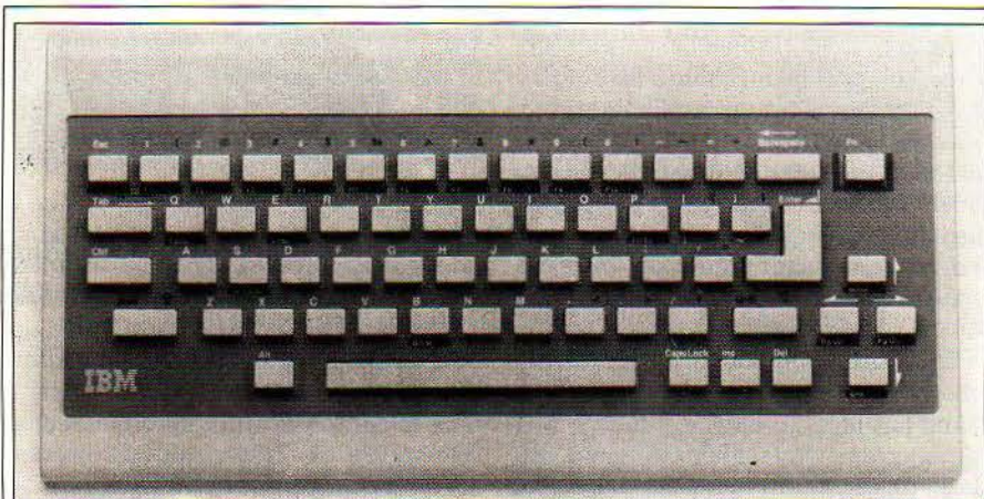
Frappe molle et imprécise, inscriptions difficiles à déchiffrer... un clavier bien décevant. Mais les touches FN (en haut à droite) et ALT (en bas à gauche) multiplient ses possibilités.
