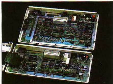
Côte à côte, les circuits du 600 XL (au premier plan) et du 800 XL. Ces derniers, plus encombrants, comportent 64 Ko de mémoire vive au lieu de 16 pour le 600 XL.
