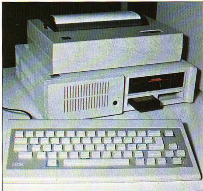
Derrrière le clavier, l'unité centrale (modèle complet). Surmontée de la nouvelle imprimante thermique, elle comprend un lecteur de disquettes. Dans l'une des deux fentes prévues, une cartouche de programme en mémoire morte.
