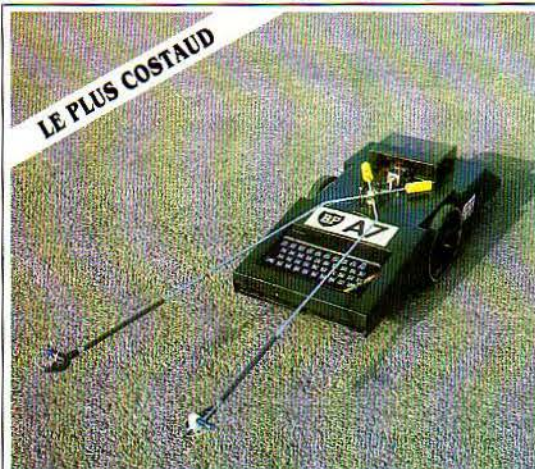
PAS D'ÉCONOMIES SUR LE MÉTAL POUR CET ENGIN INTÉGRÉ, QUI TRANSPORTE UN SPECTRUM AVEC LUI. AU BOUT DES LONGUES PINCES, UN FAISCEAU LUMINEUX : QUAND IL EST INTERROMPU PAR LE CUBE, LES PINCES SE REFERMENT. ÉCOLE GATEACRE DE LIVERPOOL.
