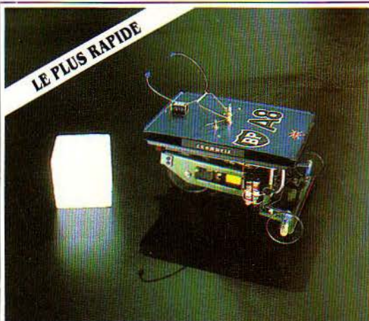
LE PLUS RAPIDE VINGT CENTIMÈTRES DE LONG, 1 400 G ET L'ALLER ET RETOUR EN 5 S. PAS DE MICRO-PROCESSEUR, UNIQUEMENT DE LA LOGIQUE CABLÉE : LE TRIOMPHE DE LA SIMPLICITÉ. PREMIER PRIX (TÂCHE IMPOSÉE), PRIX DE PLANIFICATION, PRIX DE RÉALISATION. ÉCOLE HINCHINGBROOKE DE HUNTINGDON.
