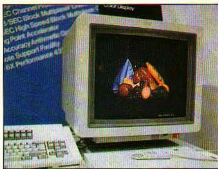
L'écran graphique couleur modèle 5081 de IBM offrant une résolution de 1024 x 1024.
