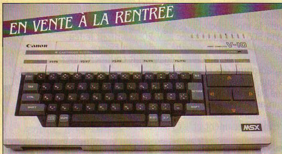
CANON V 20 : Identique au V 10 photographié ici à l'exception d'une mémoire vive accrue (64 Ko au lieu de 16 Ko), il sera mis en vente à la rentrée. Deux connecteurs de cartouches de programme ou d'extension.
