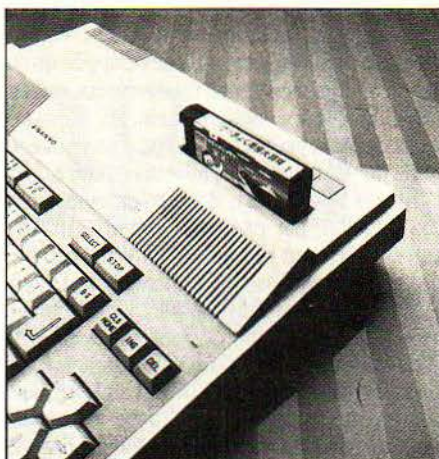
Les ordinateurs familiaux MSX privilégient les logiciels sur cartouches par rapport à ceux sur cassettes. Le Sanyo PHC 28 possède deux connecteurs de cartouches.
