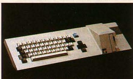
impressionnante d'extensions, dont des lecteurs de disquettes 5 1/4 pouces de 320 Ko, un disque virtuel de 256 Ko, une interface IEEE 488, un convertisseur analogique-numérique, une horloge, une interface vidéotex... Encore plus impressionnante est la liste présentée de 44 logiciels en cartouche, cassette ou
