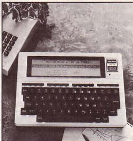
des trois à posséder une véritable interface vidéo. Il peut se servir d'un moniteur à la place de l'écran à cristaux liquides intégré. Malheureusement, cette interface est uniquement monochrome. Cinq logiciels sont intégrés à la
