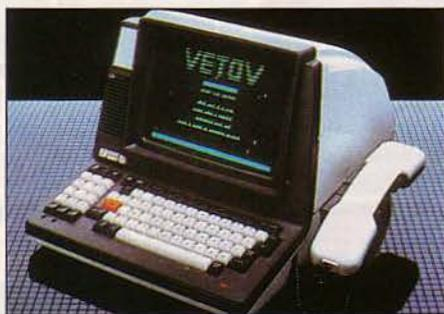
ASCII (celui des ordinateurs), possède un écran incorporé de 25 lignes de 80 caractères, un clavier alphanumérique avec 4 touches de fonction et un dispositif de connexion automatique. Prix : 12 000 F H.T. Encore quelques petits perfectionnements, une bonne cure d'élégance et une baisse de prix, et nous y serons... (Thomson CSF, 146, bd de Valmy, 92707 Colombes, tél. : (1) 785.45.45).
