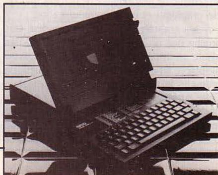
MICROPROCESSEURS : Intel 8086 à 5 MHz ; coprocesseur 8087.
