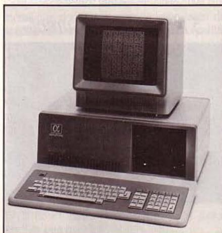
MICROPROCESSEURS : 8085 à 3MHz et 8088 à 5 MHz.
