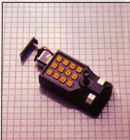
*Une manette de jeu montrant le logement de la pile d'alimentation de l'émetteur-récepteur infrarouge.*
