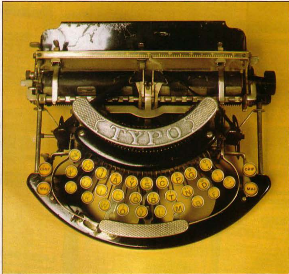
1915 : la "Typo", barres et claviers interchangeables, pour tous les goûts !
