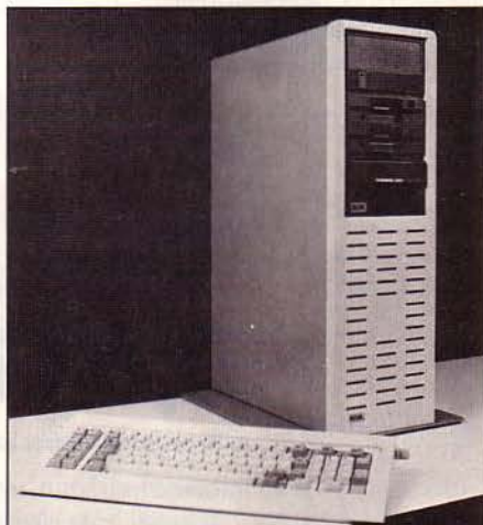
Le serveur de réseau local MBM comprenant 2 disquettes 320 Ko, 1 disque 60 Mo et sa sauvegarde sur bande. Le clavier donne l'échelle.
