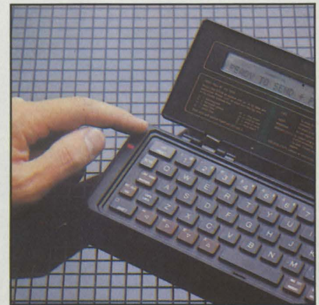
Pressez le bouton. Le voyant rouge s'allume. L'appareil est prêt à transmettre.
