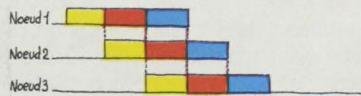
La commutation de paquets : le message peut commencer à être envoyé vers le nœud suivant après réception du premier paquet.
