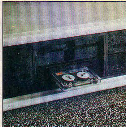
La cartouche de sauvegarde de 10 Mo prend place en dessous d'un lecteur de disquettes demi-hauteur.
