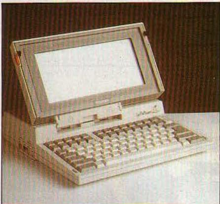
Le Papman est un portable avec écran plat de 25 lignes et clavier compatible avec celui de l'IBM PC.
