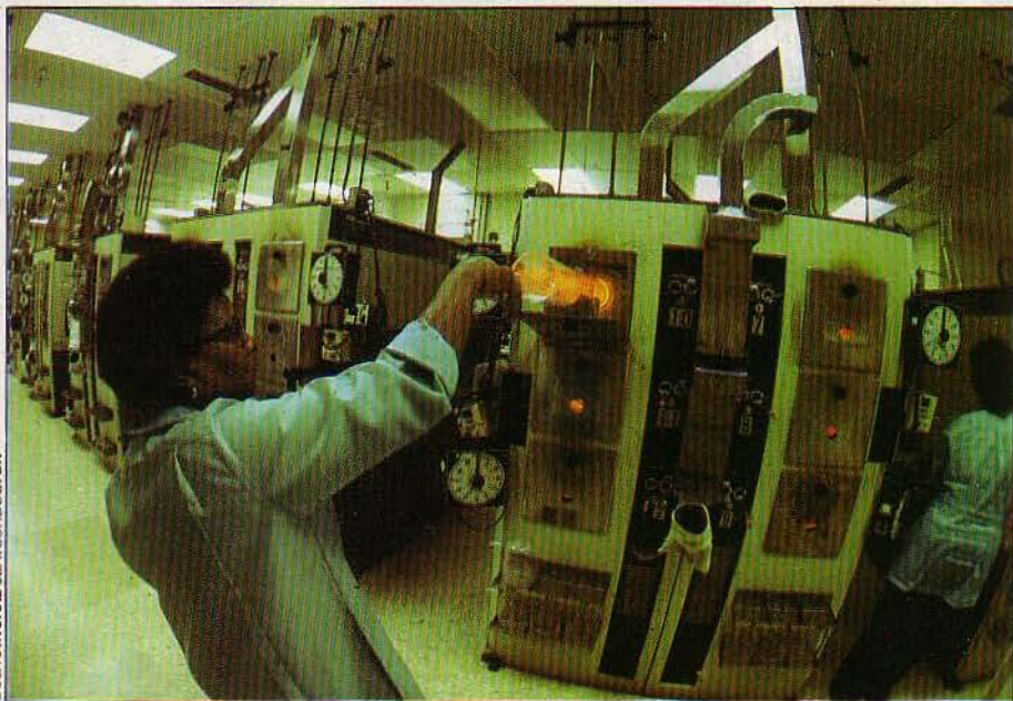
Une usine de circuits intégrés de National Semiconductor à Santa-Clara (US) : la sortie des tranches de silicium d'un four à diffusion.
