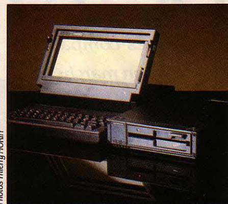
Le Grid Case peut se connecter à plusieurs périphériques externes, dont un lecteur 5 1/4 pouces qui assure la lecture des disquettes au format IBM.
