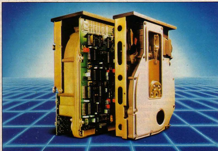
Deux disques de 25 millions de caractères. A gauche, le modèle 1983, à droite, le modèle 1985 réduit de moitié.
