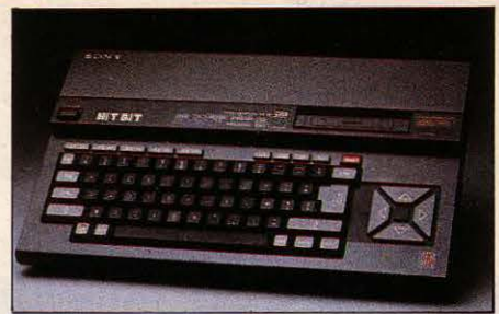
SONY HIT-BIT 64 Ko RAM, clavier AZERTY, sortie RVB Pétitel, alimentation intégrée. Prix : 3 390 F Distributeur : Sony-France. Tél. : (1) 739.32.06.
