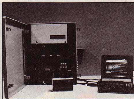
L'unité centrale du Synforic reçoit les informations des UCL. Elle est gérable à distance par le Minitel.
