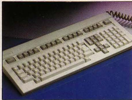
Un clavier très complet avec 3 blocs bien séparés et pas moins de 25 touches de fonction dont « recherche » et « remplacement ».
