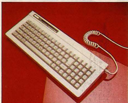
Le clavier mécanique, AZERTY accentué mais un peu encombré, a des touches spéciales comme « couper », « copier », « coller ».
