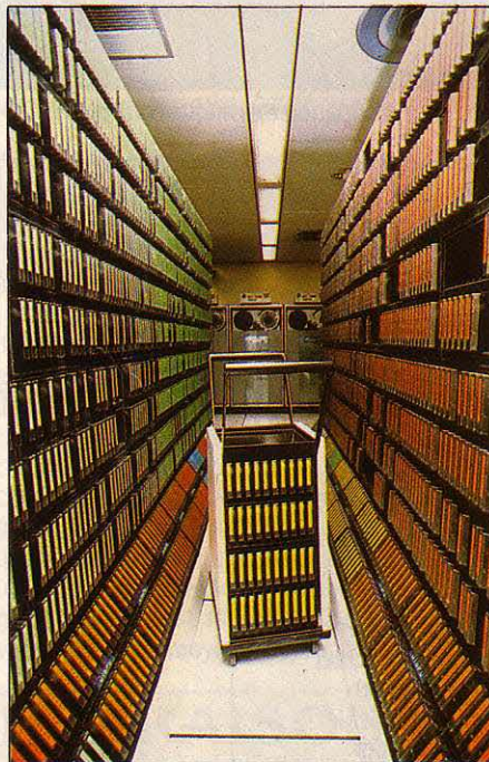
Les racks de stockage des cartouches magnétiques d'une capacité de 200 millions d'octets dans la salle des lecteurs du GAN.
