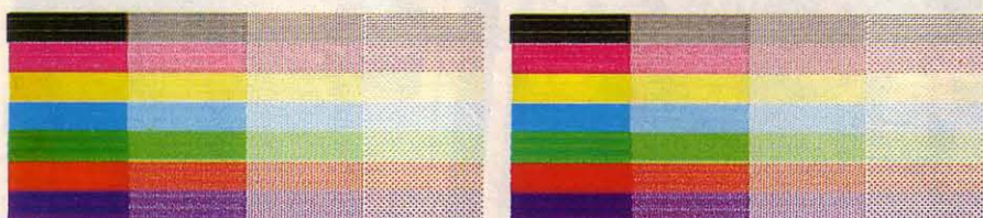
La tête d'impression de l'IO-700 Sharp utilise quatre gicleurs pour chaque couleur, d'où une meilleure résolution.
