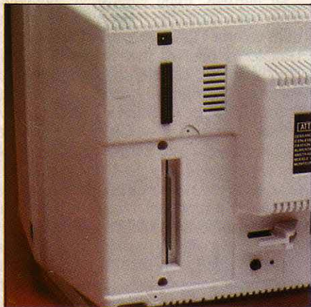
De haut en bas, l'alimentation, l'interface de l'imprimante et le connecteur pour la future interface série-parallèle.
