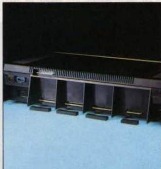
A gauche, les sorties son, imprimante et Péritel. Face aux capuchons, 3 bus identiques, et la prise pour extension mémoire.
