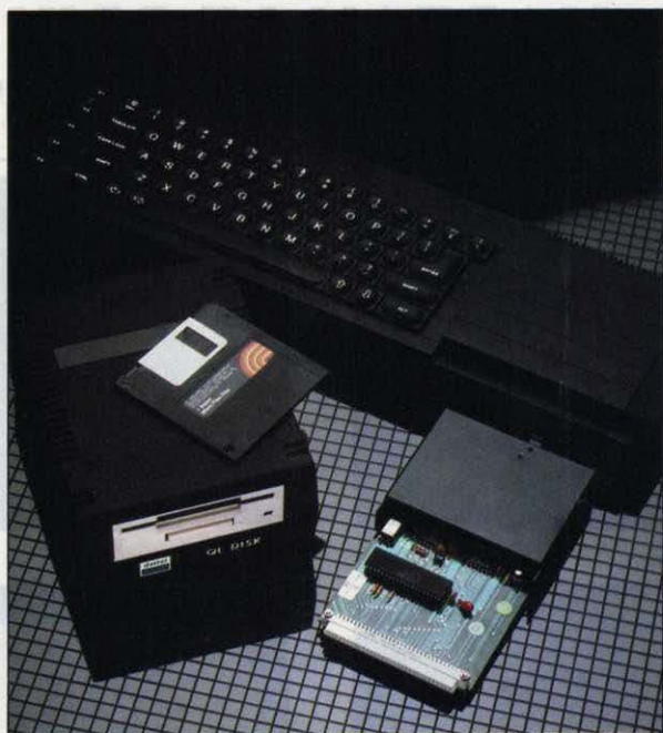
Le lecteur de disquettes QL Disk de Dattel au format 3 1/2 pouces (à gauche), et son contrôleur dont la partie dénudée s'enfonce dans le connecteur d'extension du QL (à droite).
