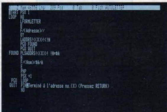
Un programme de mailing en WPL, le langage de traitement de texte inclus dans Applewriter.
