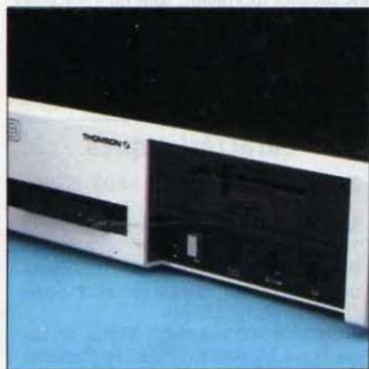
Le lecteur de disquettes 3 1/2 pouces avec prises pour clavier, crayon optique et magnétophone et le connecteur de cartouches.
