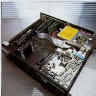
L'intérieur du Laser PC : des possibilités d'extension supérieures à l'IBM PC.
