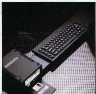
Le bloc rigide lecteur-contrôleur-ordinateur : impossible de déplacer le clavier à sa guise.
