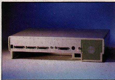
A l'arrière, un alignement impressionnant de connecteurs. A droite, le ventilateur de l'alimentation électrique qui fonctionne silencieusement.
