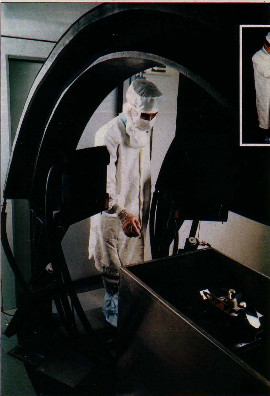
Le simulateur de viseur de terre (ci-contre) et le simulateur de viseur d'étoiles (ci-dessus) de la Sodern.
