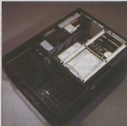
La nette séparation entre la partie disque du G40 et celle réservée aux cartes additionnelles, avec ouverture séparée du coffret.
