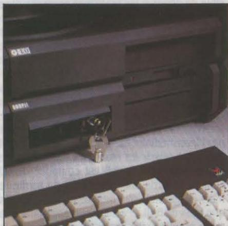
La face avant du G40 offre trois emplacements demi-hauteur et la clef de blocage du clavier, symbole de la norme AT.
