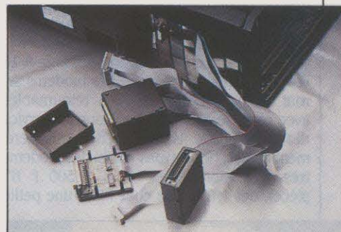
3. Installation des boîtiers de connexion aux modems
