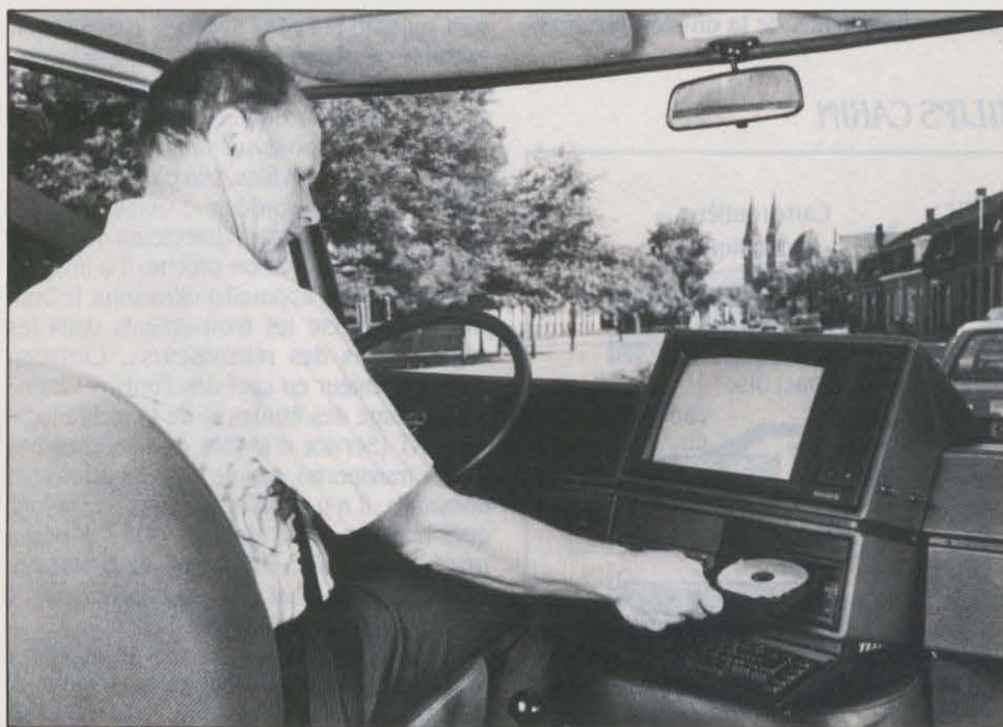
Le système Carin de Philips, une synthèse de tous les systèmes existants : ordinateur de bord avec lecteur de CD-ROM, boussole électronique, réseau de capteurs et... audio-radio !
