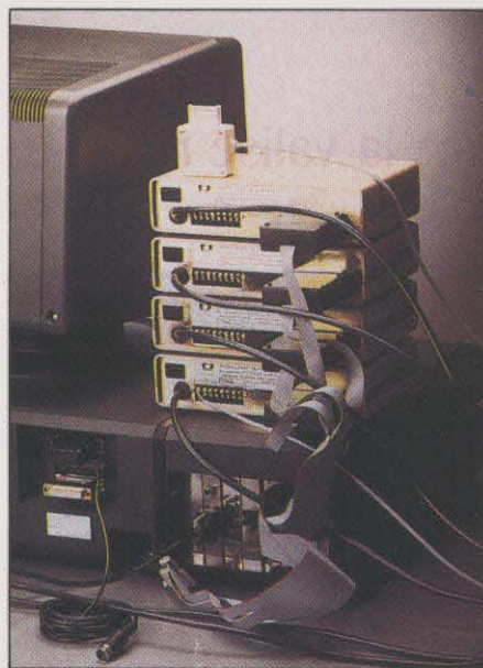
5. L'arrière du serveur en ordre de marche. Remarquez le bouchon de protection sur la sortie parallèle, et le câble de liaison au Minitel de composition branché sur la sortie série.
