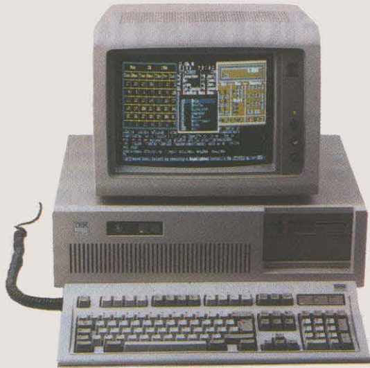
L'IBM PC-AT 3, avec un disque de 30 Mo.
