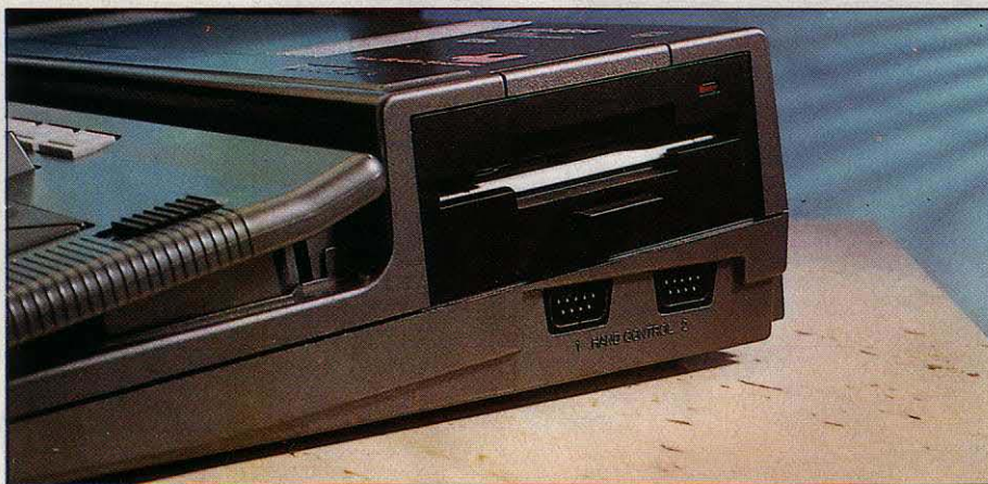
Le lecteur de disquettes intégré du VG 8235, simple face de 360 Ko.
