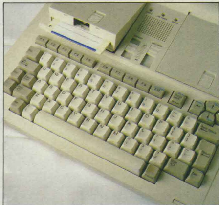
Les lecteurs 3 pouces 1/2 du Z 181 rendent l'accès impossible à beaucoup de logiciels.
