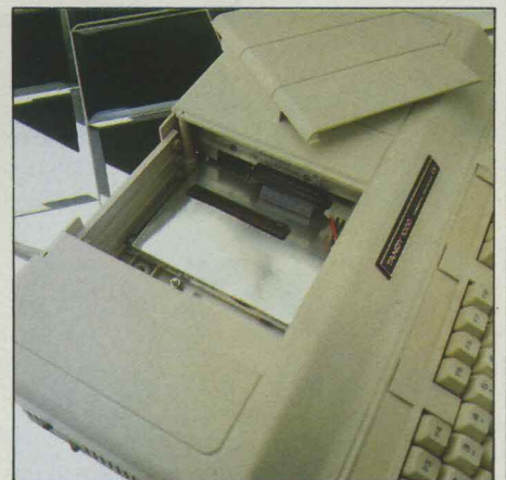
L'unique connecteur d'extension de Tandy 1000 EX, non standard.
