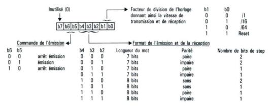
Pour le facteur de division, il faut savoir qu'en mode Minitel (bit 4 du port A du PIA à 1), l'horloge pour l'émission est de 1 200 Hz et celle de la réception est de 19,2 kHz. On a donc avec un facteur de division de 16 :
