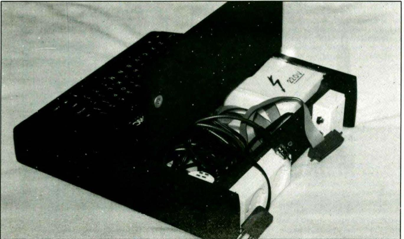
par le truchement des interrupteurs IG, BM, BP, d'assurer les séquences correctes d'enclenchement et de déclenchement. Le fonctionnement est le suivant. La fermeture de l'inter IG met sous tension, outre les périphériques, l'alimentation continue, dont la présence tension est signalée par la LED rouge ; le relais R n'est pas excité, donc le micro n'est pas alimenté. L'appui
