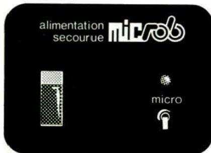
Sortie micro secourue par batteries (autonomie 15 mn) alimentation peritel prise 220 V aux. commutée A / Marche 220 V. A / Marche micro (RAZ) livrée avec cables et batteries en coffret.
