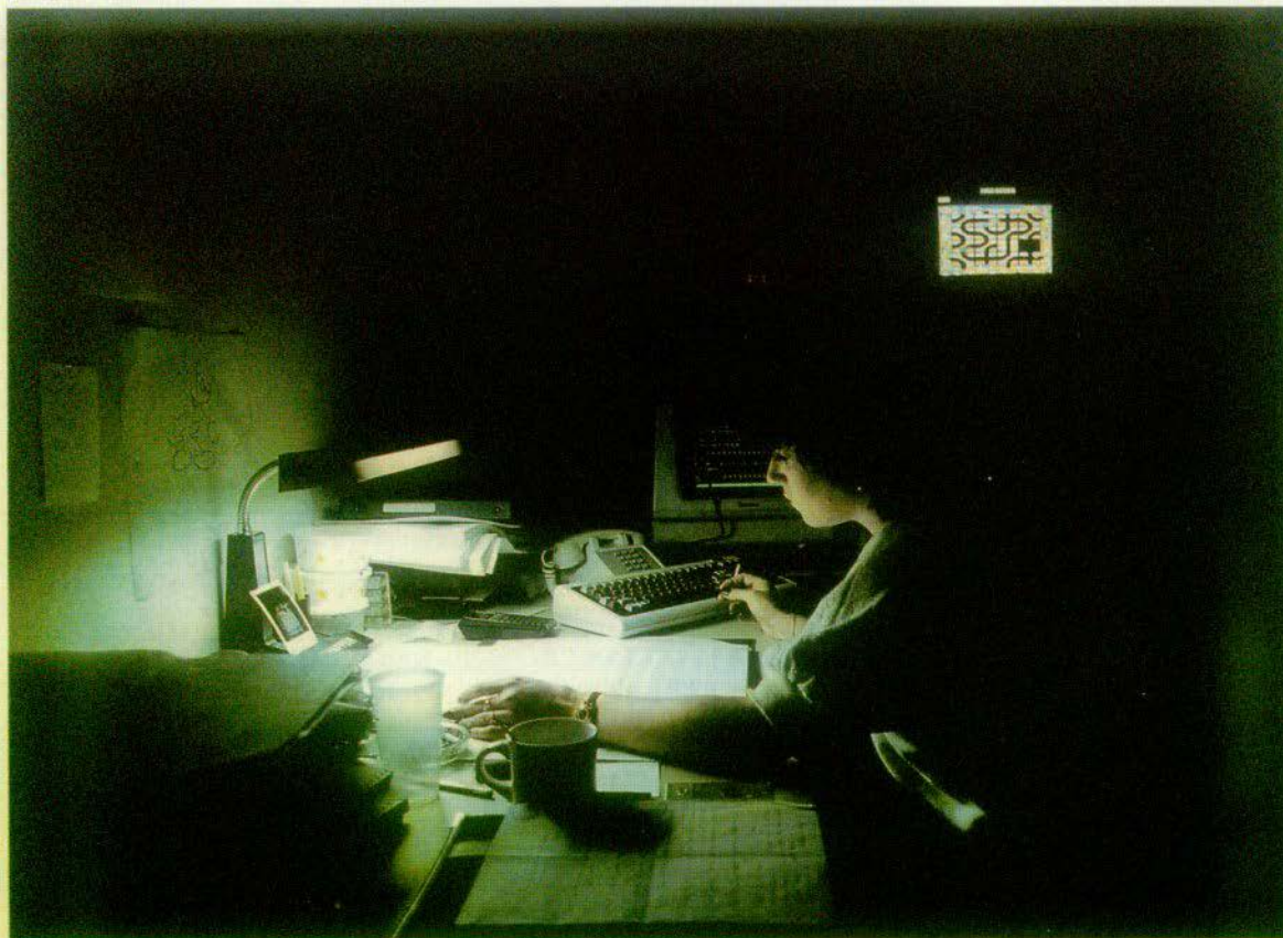
La station de mise au point est dotée d'un "logic analyzer" qui permet d'observer avec beaucoup de précision ce qui se passe dans la console pendant que le programme se déroule.
