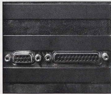
Eh oui, une prise de type « Joystick Atari », utile pour certains périphériques.
