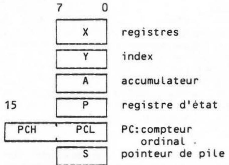
L'accumulateur A est le principal registre de calcul. Sa largeur est de 8 bits. C'est sur lui que sont effectuées la plupart des opérations arithmétiques : la plupart des opérations sont effectuées entre l'accumulateur et une case mémoire et le résultat se retrouve dans l'accumulateur.
