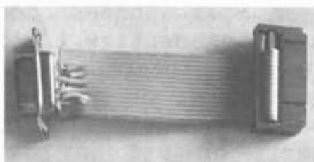
Pour un montage plus professionnel, il faut prendre un connecteur pour câble plat 2x10 contacts 3M SCOTCHFLEX 3421 - 6000 et un connecteur Cannon D mâle, 9 contacts. L'un et l'autre coûte 20 à 25 F.
