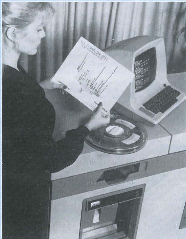
L'unité d'entrée d'une imprimante à laser (ici Xerox 150) permet de saisir graphiques et photographies. Les données (texte à imprimer, fond de page, police de caractères, illustrations, etc.) sont codées numériquement et stockées sur une bande ou un disque magnétique. Ce document « virtuel » est transmis à l'imprimante qui assure la mise en page et l'impression. (Document Rank Xerox.)
