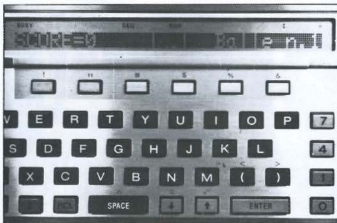
Photo 1. - La routine INVERSE permet d'obtenir une « inversion vidéo » sur l'afficheur.
