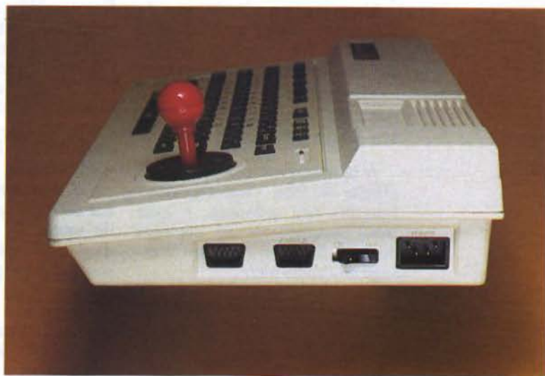
A droite du boîtier : l'interrupteur et trois connecteurs d'extension.
