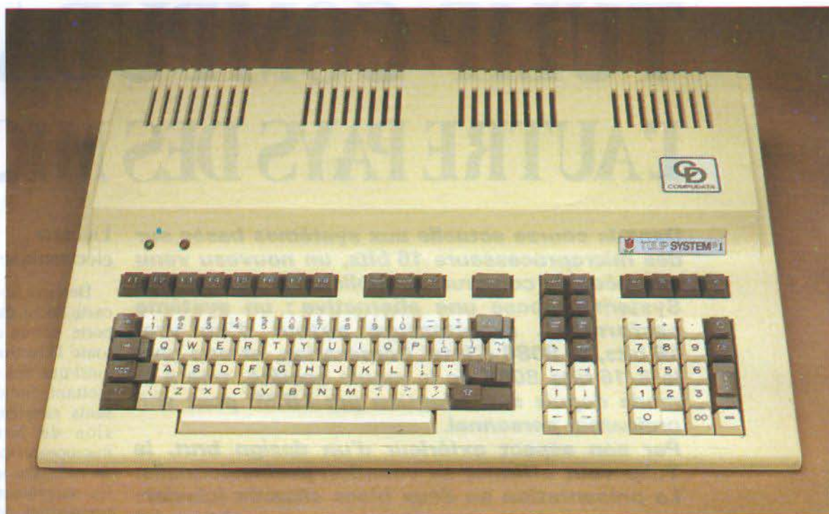
Le clavier du Tulip inclut 104 touches réparties en trois blocs. On notera les touches de gestion de curseur et celles de fonction.
