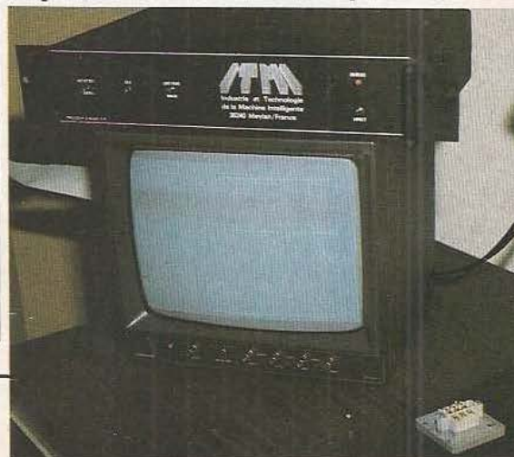
Reconnaissance de formes mise en pratique dans une «station de déchargement» de relais. Ceux-ci, placés dans un bac sont reconnus et saisis même s'ils sont mal orientés. Pour le moment le système ne traite que d'une seule phase d'équilibre.
