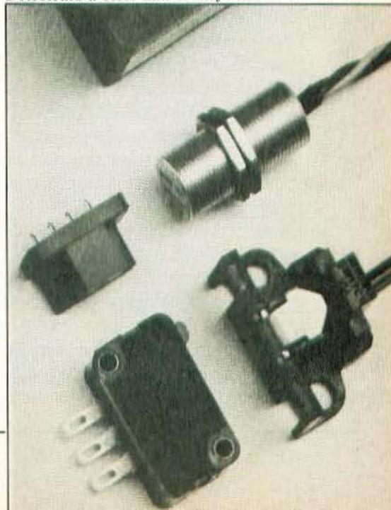
circuits. Leur surface sensible leur permet en outre une mise en place quasiment universelle et ils peuvent, ainsi, capter des mouvements de très faible amplitude si on les associe à des aimants puissants subminiatures (samarium cobalt). Le fonctionnement entièrement statique de ces dispositifs leur ouvre la possibilité de travailler du continu jusqu'à des fréquences de l'ordre de la centaine de kilohertz.
