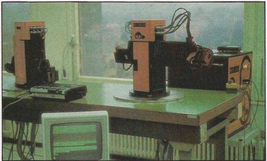
Contrôle d'un cycle d'assemblage sur un MR03. Au premier plan un micro-ordinateur visualise les différentes phases du cycle.
