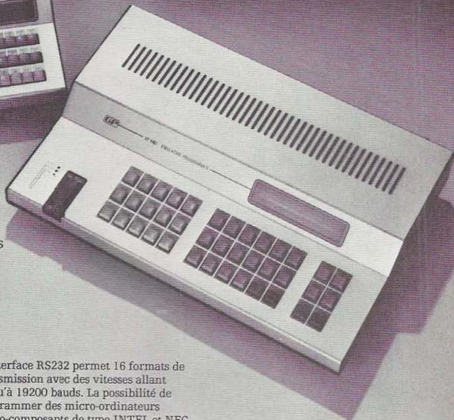
L'interface RS232 permet 16 formats de transmission avec des vitesses allant jusqu'à 19200 bauds. La possibilité de programmer des micro-ordinateurs mono-composants de type INTEL et NEC, jusqu'à 512 KO. de mémoire et ceci pour un prix de 12 500 F.
