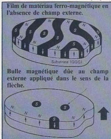
Fig. 1. Comportement d'un matériau ferro-magnétique en présence d'un champ magnétique (doc. Fujitsu).
